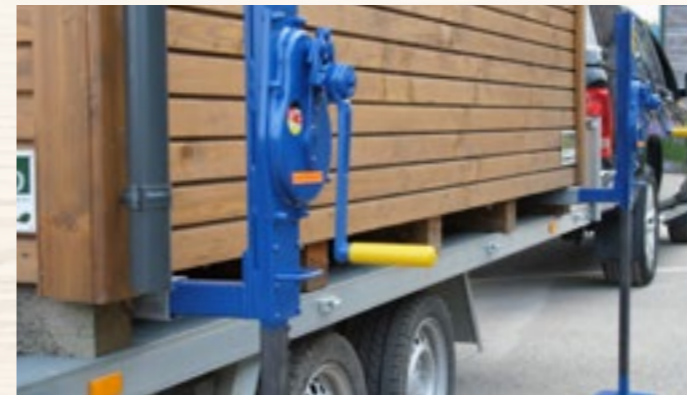
Positionierung aller 4 Kurbeln um Gewicht gleichmäßig zu verteilen
