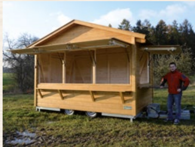
Absenkbarer Hänger im abgesenkten Zustand
