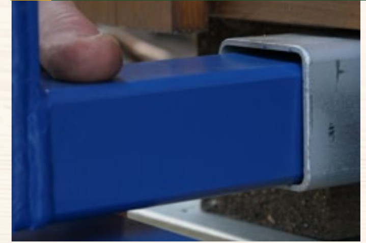
Anbringen der Winden in die kompatiblen Aufnahmen
